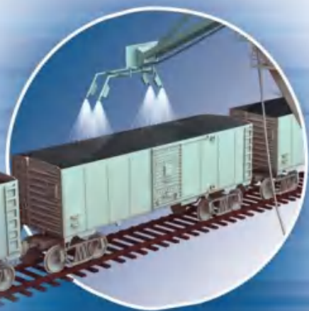
物料铁路运输防尘
